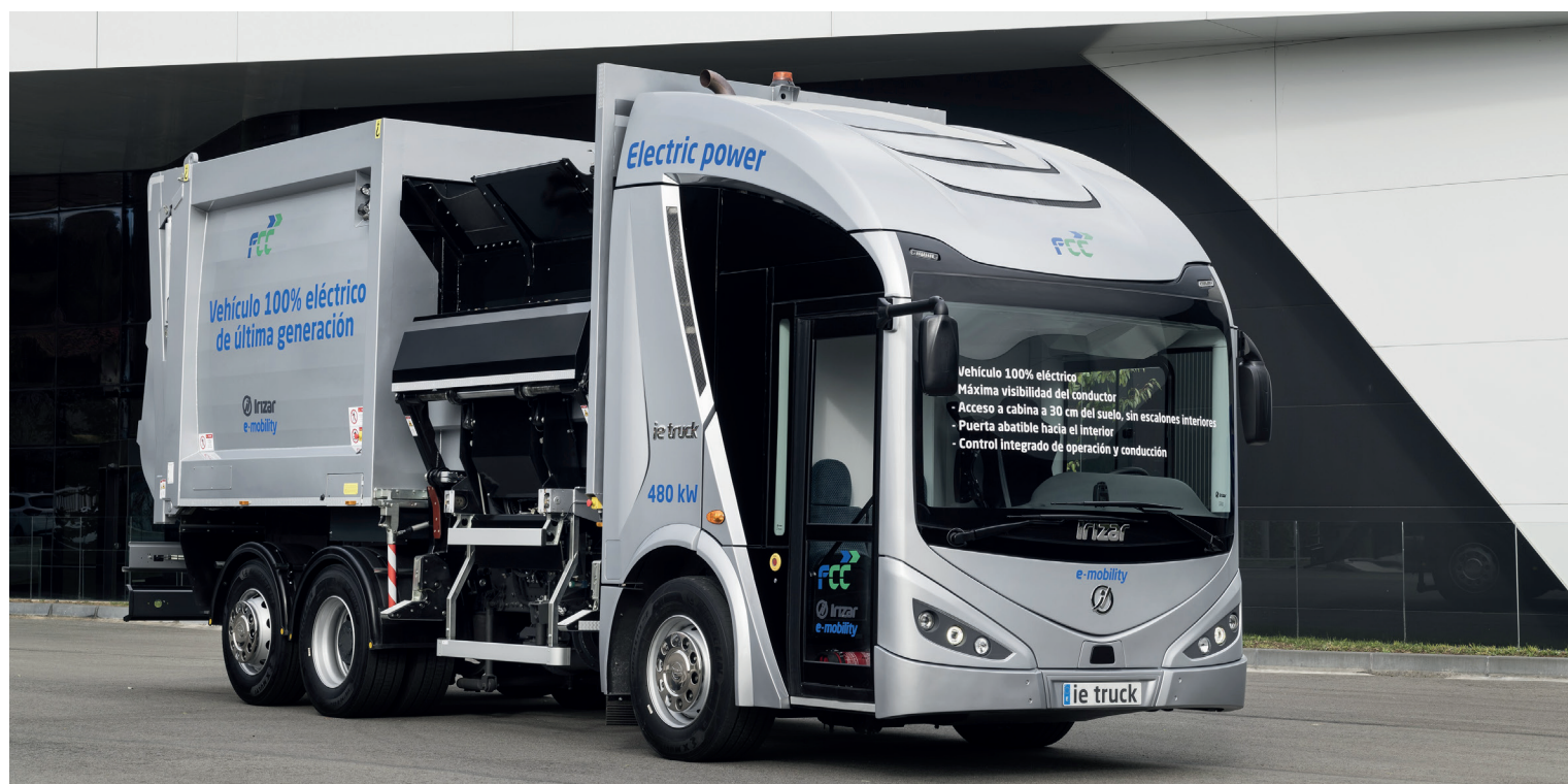
El área de Servicios Medioambientales del Grupo FCC realizó la presentación mundial de la primera plataforma de e-mobility para vehículos de Servicios. En la imagen el vehículo 100% eléctrico, enchufable, auto-recargable y totalmente reciclable.
