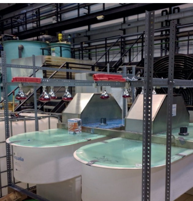
Fotobiorreactores tipo carrusel instalados en la planta de tratamiento de aguas residuales de la URJC (Centro de Apoyo Tecnológico, Campus de Móstoles) antes de iniciar su operación.
